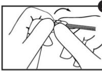
2. Serrer l'écrou d'extrémité à la main. Pour repositionner l'embout, l'enfoncer en tournant dans le sens des aiguilles d'une montre.
